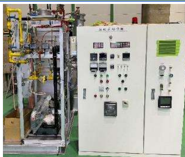
浸炭処理ガス生成用 変成炉の導入
